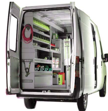
Abb. Sicherung der Ladung mit Hilfe geeigneter Fahrzeugeinrichtung
