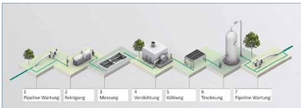
Abbildung 4-4: Komponenten einer Erdgasverdichterstation, /GCA01 11/
